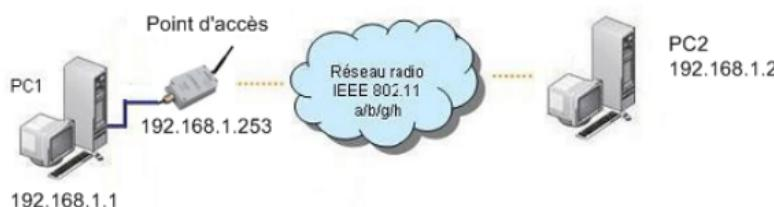
Paramétrez la connexion sans fil du PC2 selon les paramètres d'usine fixés dans le point d'accès (802.11b/g, SSID ACKSYS, sans sécurité).
